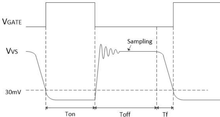
图 4: 辅助绕组波形及退磁检测
