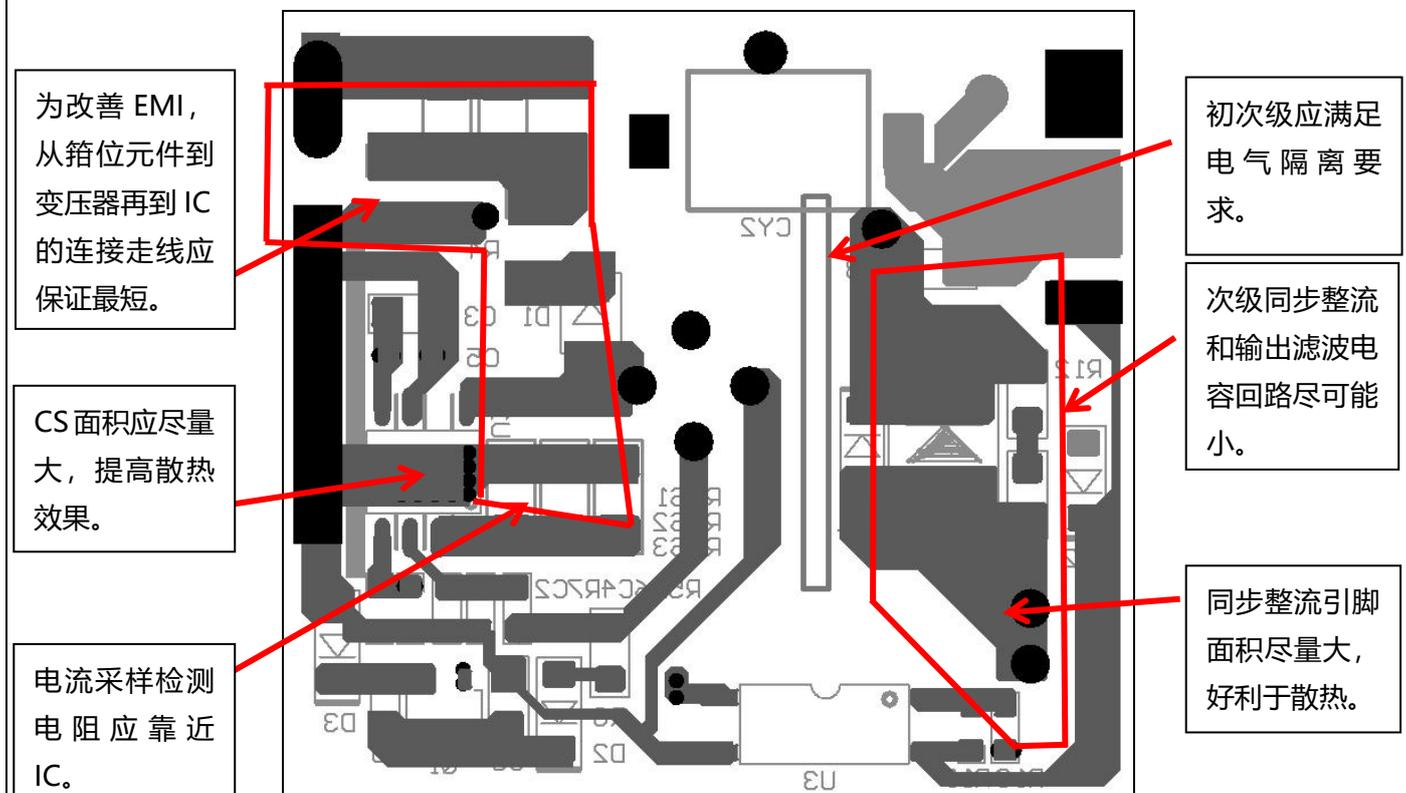
为改善 EMI，从箝位元件到变压器再到IC的连接走线应保证最短。
